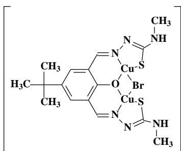
Complexul dat reprezintă un compus coordinativ binuclear al cuprului(II) în care în calitate de ligand organic servește 2,2'-[(5-(tert-butil)-2-hidroxi-1,3-fenilen)bis(metaniliden)]bis(N-metilhidrazin-1-carbochioamida), care în compusul complex îndeplinește și funcția de ligand-punte.
